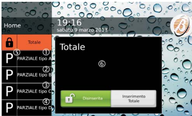
Figura 24 Inserimento con tastiera Touch: le etichette 1, 2, 3 e 4 possono essere personalizzate, come spiegato nel testo; nella posizione 5 sarà messa la lettera iniziale dell'Inserimento Speciale corrispondente; nella finestra 6 comparirà la descrizione assegnata all'inserimento selezionato, come spiegato nel testo.
